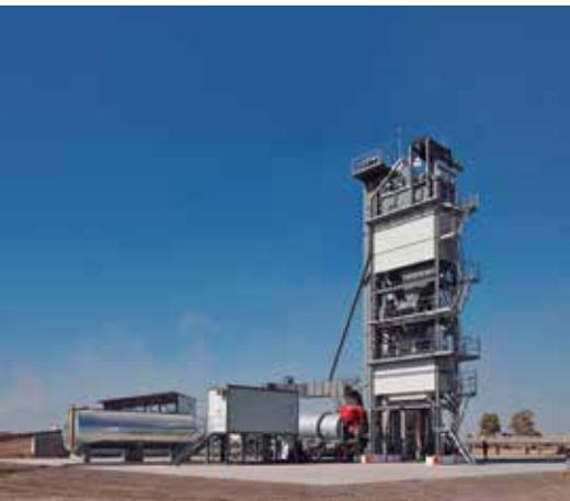
▲ Usina asfáltica gravimétrica da Ammann, com a capacidade produtiva de 140 e 180 toneladas por hora
