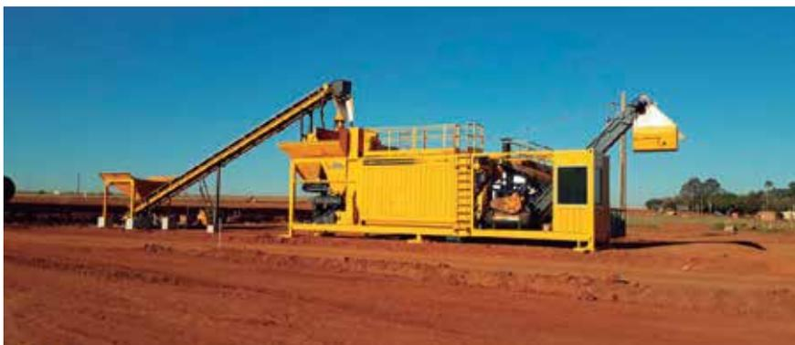
▲ Usina de asfalto em formato de container, da Lintec-Ixon
