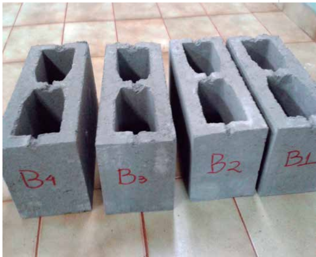
► Blocos de concreto com flocos de plástico em sua composição ganharam função estrutural para uso em elementos de alvenaria
