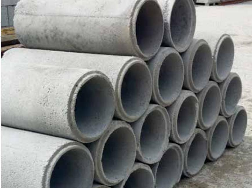
◀ Os tubos e aduelas são fabricados com “concreto seco”, ou seja, com menor quantidade de água
