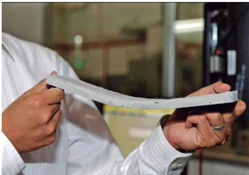
des de borracha fragmentada de pneus reciclados combinados com pedaços de aço em formato de palitos.
