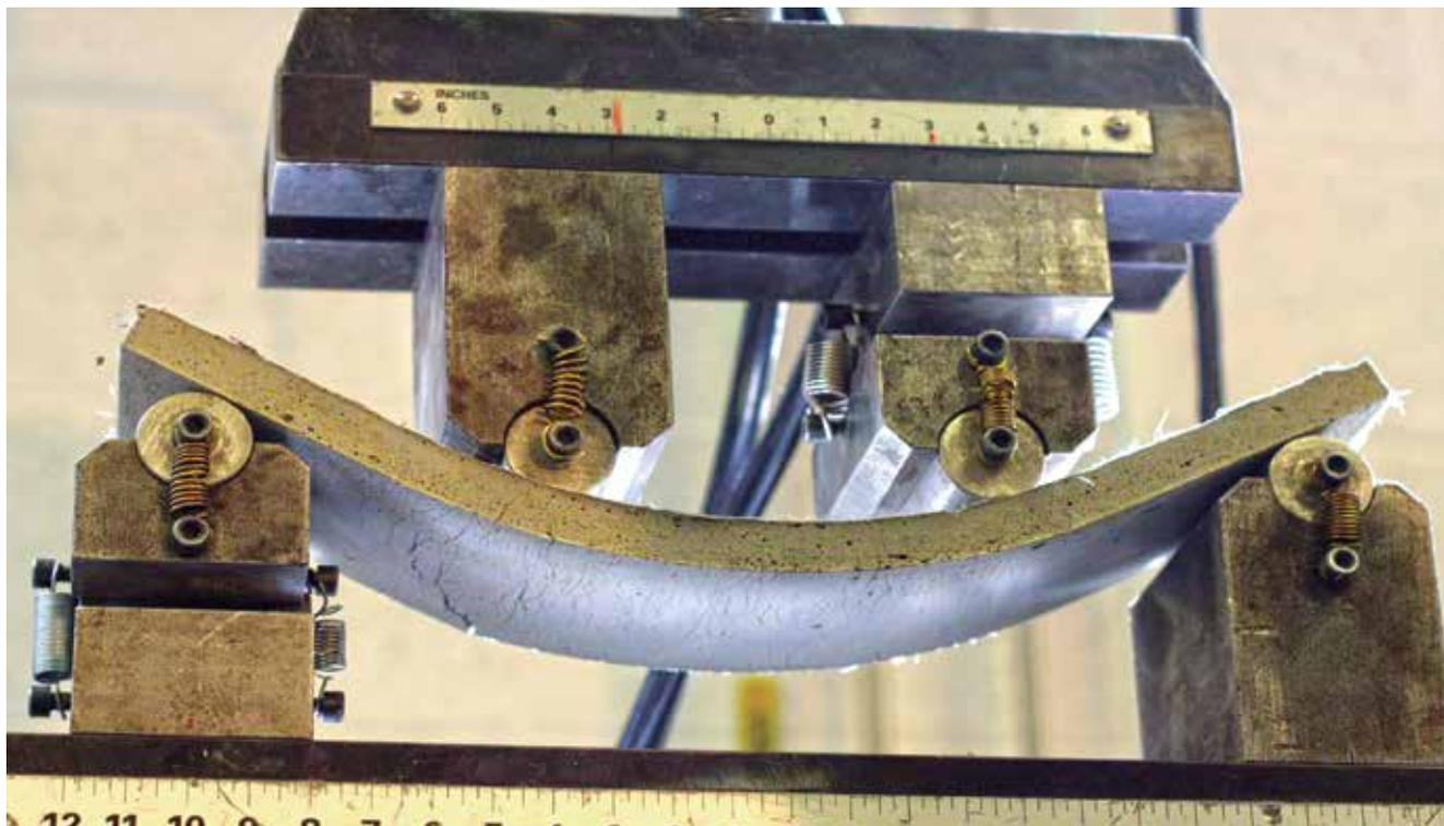
▲ Menos suscetível às fraturas e rachaduras, o ConFlexPave, conta com microfibras de polímero sintético, além do cimento, água e agregados
