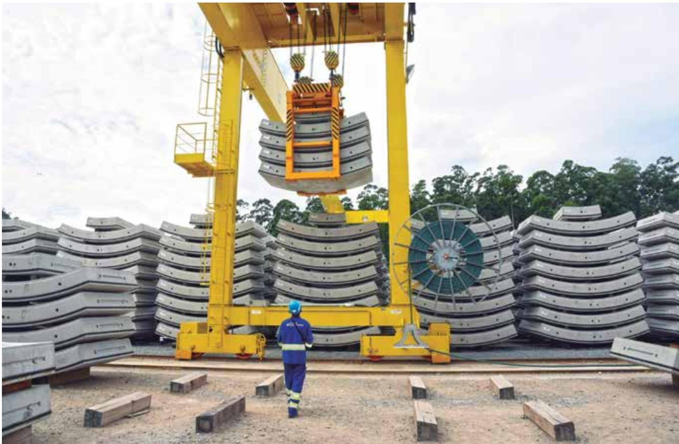
▲ Fábrica das aduelas de concreto no bairro do Perús: estoque suficiente para 1,5 km de túneis
