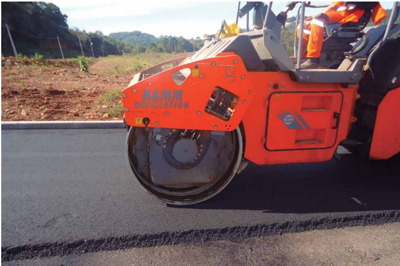
▲ A tecnologia da oscilação garante menos impacto ao cilindro, o que se traduz em maior vida útil
