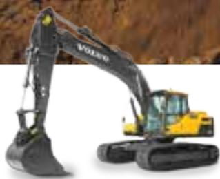
A nova série D de escavadeiras Volvo com o novo sistema hidráulico gerenciado eletronicamente deixa o equipamento mais potente e produtivo.
