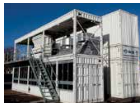
Sistema de Resfriamento de Agregados ACS
