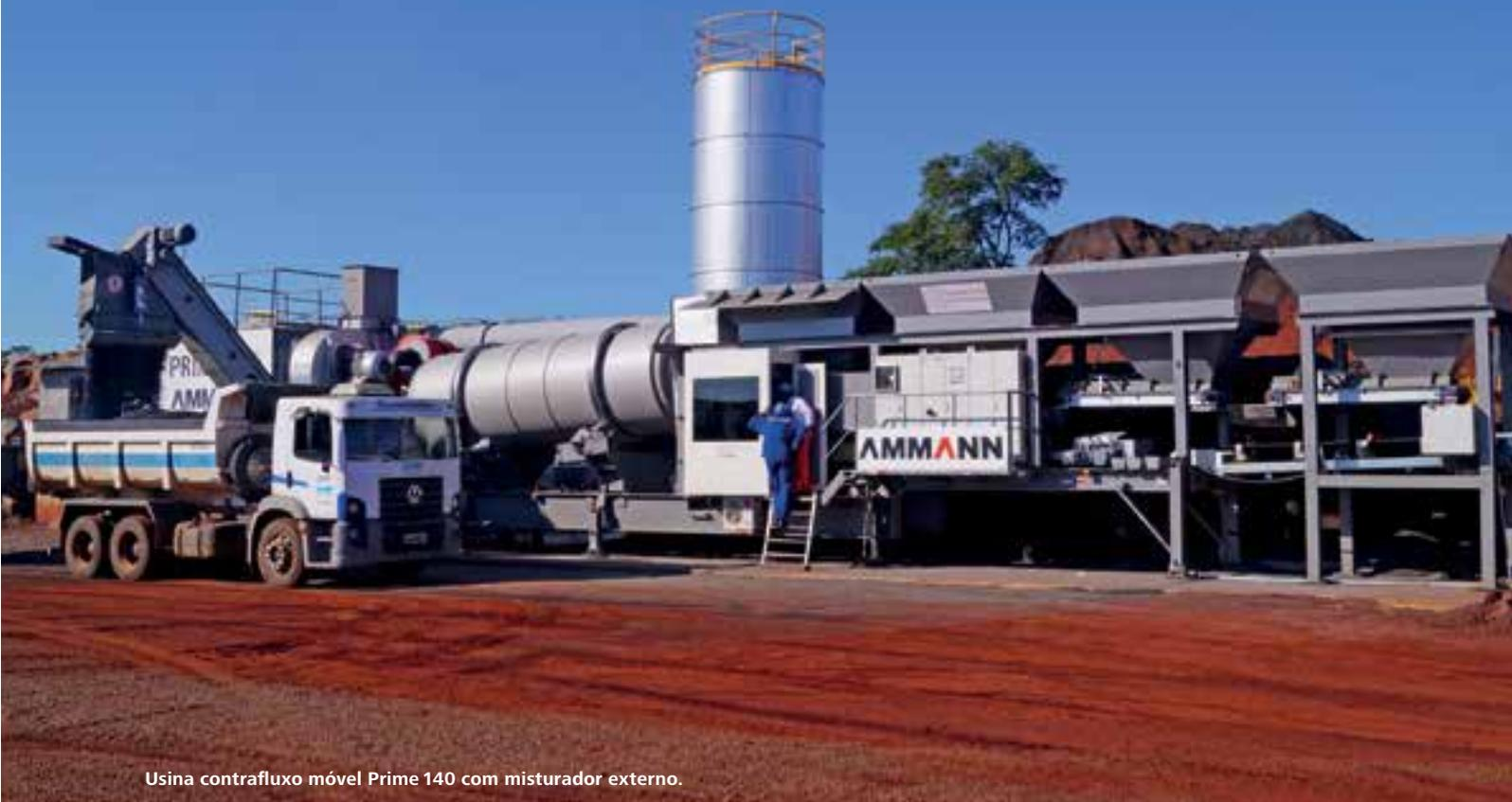
Usina contrafluxo móvel Prime 140 com misturador externo.
