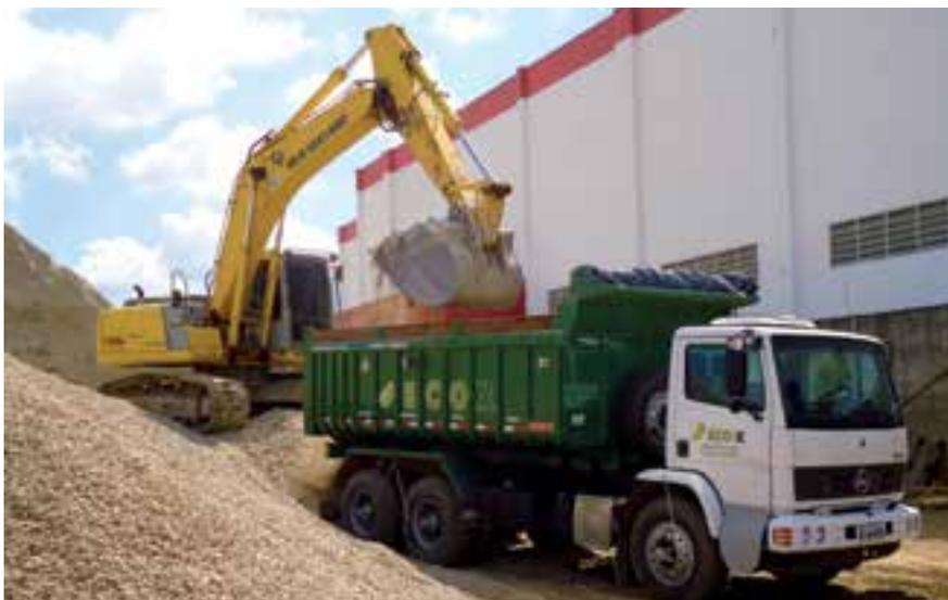
▲ Brita Reciclada, obtida a partir da britagem de resíduos de concreto da construção civil e demolição
