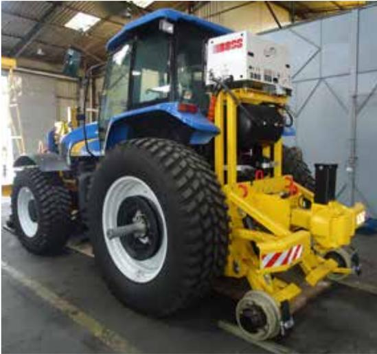
A Empretec reservou para a NT Expo duas novidades: o lançamento do rebocador de grande porte 100% nacional e o veículo rodoferroviário para manutenção de via e transporte de ferramentas e pessoal. O rebocador tem como máquina base um trator industrial nacional acionado por motor diesel.
