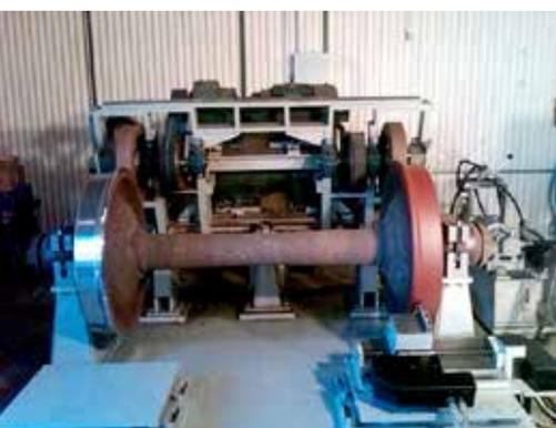
A Maven Engineering Corporation apresentará como novidade na NT Expo, um torno portátil CNC de retificação de perfis de rodas de locomotivas e vagões, que opera automaticamente e executa a tarefa sem o auxílio das mãos. O uso do equipamento dispensa a remoção do conjunto de rodas ou da locomotiva até o local da retífica. Fabricado por uma de suas representadas, a Delta MFG, o torno CNC
