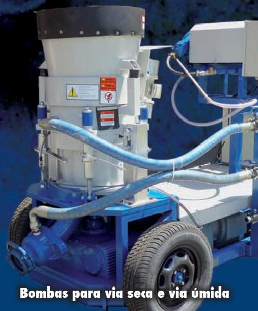
**Bombas para via seca e via úmida**
