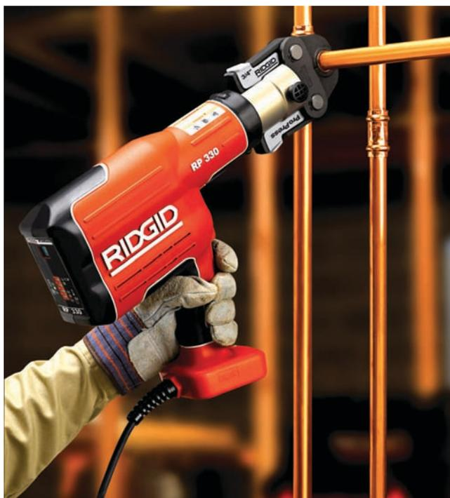
A Ridgid vai apresentar diversas ferramentas, mas a principal será a linha de Sistema de Crimpar Press-Tool que é uma novidade no mercado. Na ocasião, a empresa mostrará a crimpadora e prensadora Press-Tools, que faz prensagem e crimpagem de conexões de cobre e aço inoxidável até 70% mais rápida que uma operação de soldagem.
