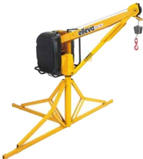
Equipado com pegadores para aproximação da carga, o equipamento possui Sistema Tangencial de fixação, com 80 m de cabo de aço de 1/4" (antitorção) fixado no carretel, possibilitando o enrolamento contínuo e sem atritos que possam causar danos ao cabo. É constituído de tubos e chapas de aço dimensionado para sua carga real sendo capaz de içar carga de até 500 kg.
