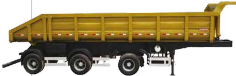
os eixos. A caixa é comprida o suficiente para atingir a medida mínima exigida, contando apenas com um mecanismo de retração do para-choque. Com uma tampa interna, à caixa de carga, conta também com inclinômetro digital de série aparelho que limita o basculamento dentro de uma inclinação segura.
