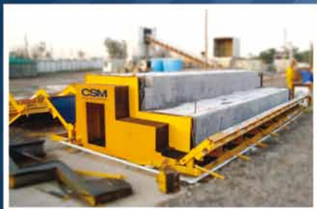
Fôrmas para arquibancada - Arena do Grêmio Construtora OAS
