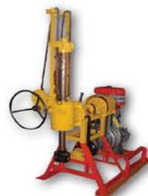
Mach 920 (equipamento versátil. Usado nos segmentos de geotecnia, estaca, poços artesianos. Pode ser montado sobre carreta rodoviária de pequeno porte, o que facilita o deslocamento através de reboque por pick-ups)
