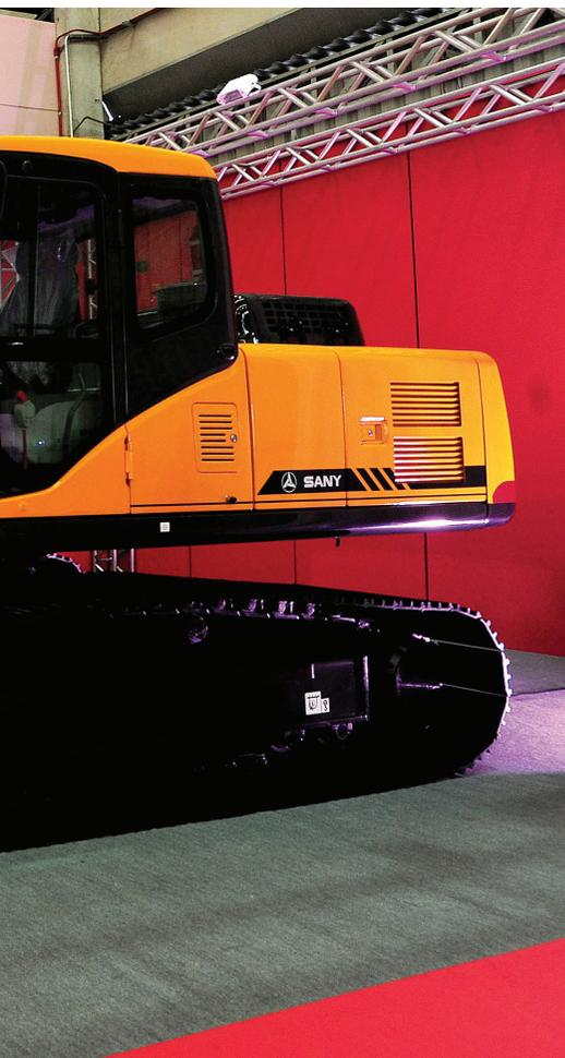
◀ Escavadeira hidráulica Sany, modelo SY 215C, com capacidade para 21,5 toneladas, montada no Brasil
