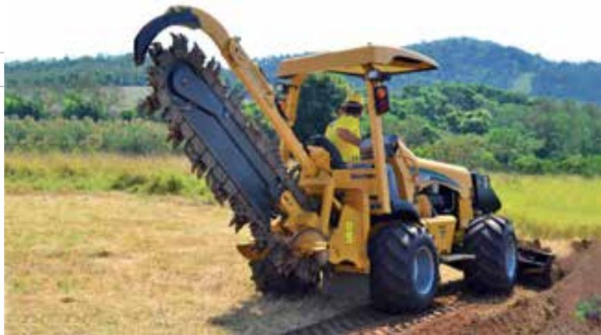
operando em uma única faixa de rua ou avenida. Nos centros urbanos, esse é um fator importante para não tornar o trânsito ainda mais caótico. As dimensões deste modelo também viabilizam o uso no acostamento de rodovias. Com um motor de 65 hp, ela abre valas em diferentes tipos de asfaltos e bases, mesmo quando há pedras ou rochas. Outro diferencial deste modelo para atender projetos em grandes centros urbanos é o disco de corte com deslocamento lateral.
