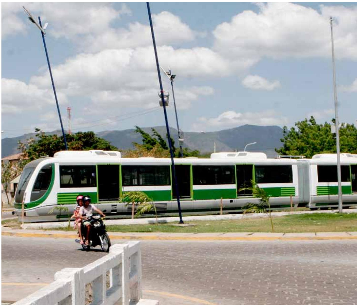
▲ O VLT será operado por seis trens, cada um com quatro carros de passageiros, tração diesel/hidráulica e capacidade total para 1.000 lugares por viagem
