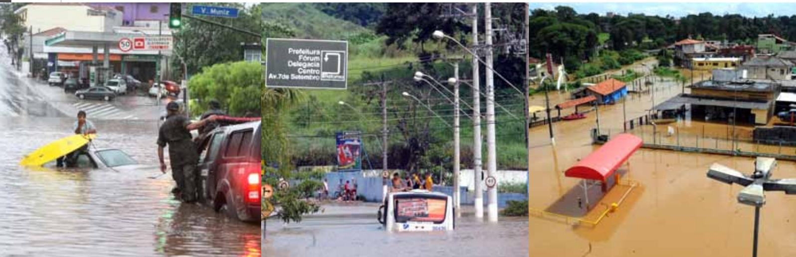
▲ Enchentes em São Paulo são resultado da impermeabilização generalizada da região, excesso de canalização de cursos d'água e da redução da capacidade de vazão do sistema de drenagem
