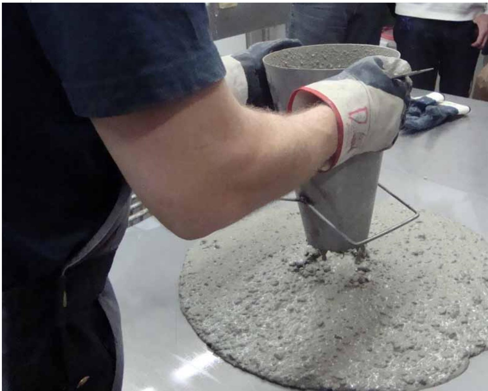
Concreto e Agregados, da Associação Brasileira de Normas Técnicas (ABNT), informa que o CAA é indicado para obras onde os elementos estruturais têm alta taxa de armadura, tanto para concreto moldado no local, como pré-fabricado. Com a tecnologia, pode-se ainda eliminar ou diminuir significativamente a ocorrência de falhas.
